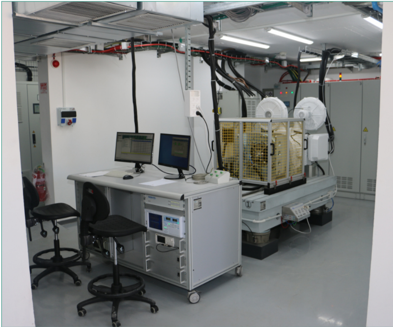
Esempio di banco di prova per motori di aerei elettrici che include la possibilità di testare motori da 1 kW fino a 140 kW, con il loro hardware
